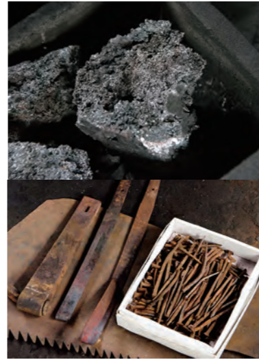
材料は玉鋼(写真上)の他に、古釘などを鋼に作り替えて使う場合も。姫路城の釘など、古い時代の純度の高い鉄しか適さないという。
